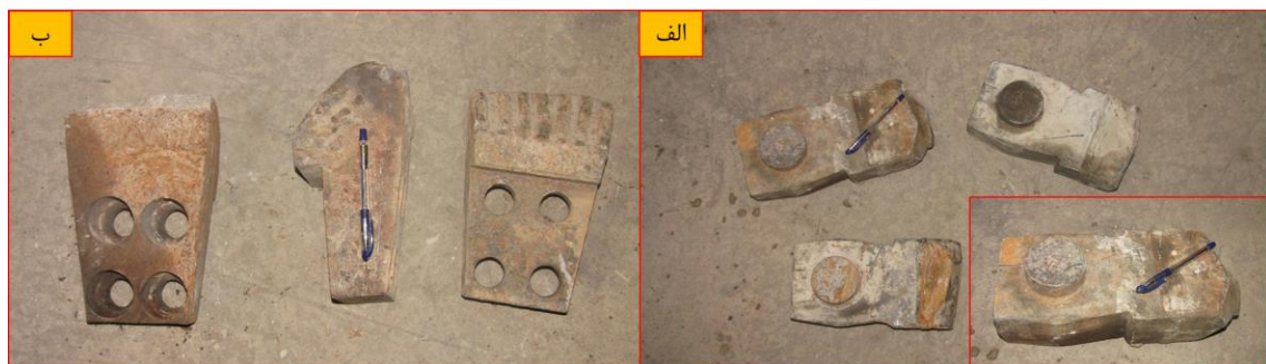
شکل ۷- الف) ریپرها ساییده شده و ب) اسکریپرهای ساییده شده
