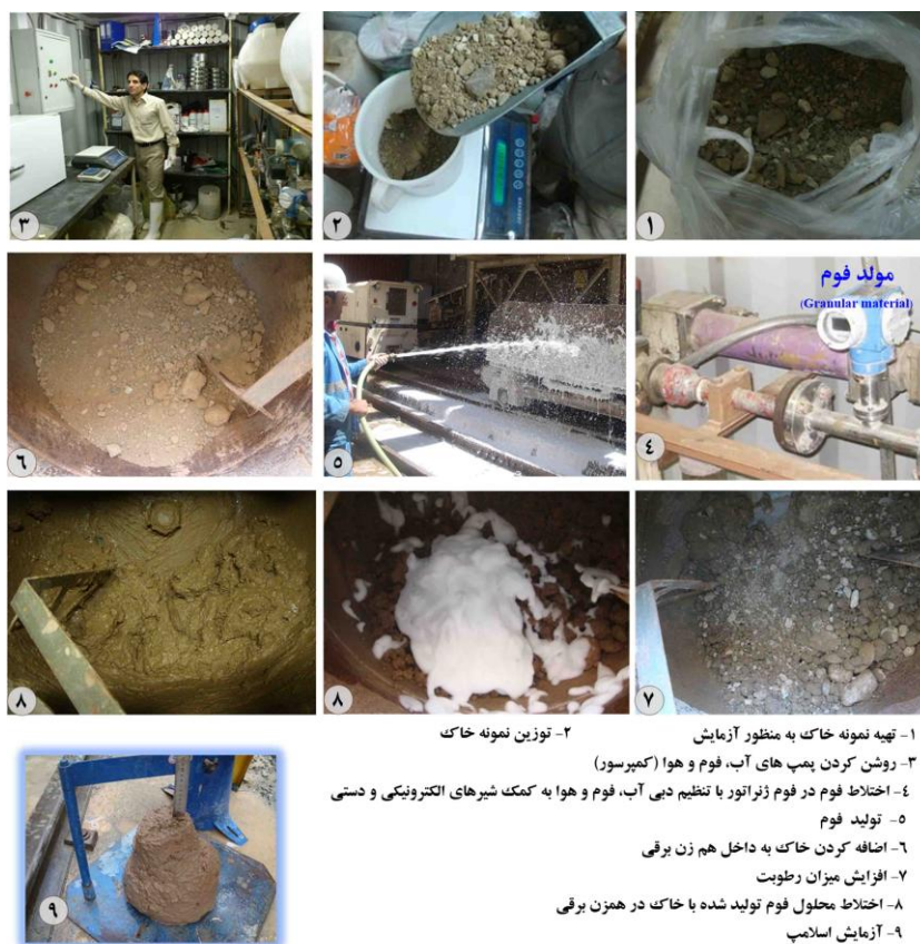
شکل ۴- مراحل تصویری از فعالیت‌های آزمایشگاه با هدف ارزیابی کارپذیری خاک با تزریق فوم
