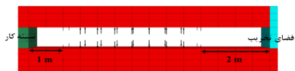
شکل ۴- نمای شماتیک اعمال تنش گسترده به سقف و کف در مدل عددی
