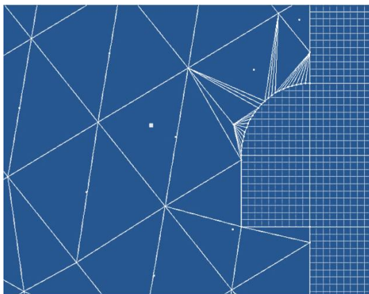
شکل ۹- ابعاد بلوک‌ها در مرز تونل: فاصله‌داری ۱٫۵ متر
