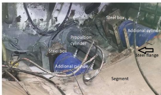
شکل ۹- نحوه اضافه کردن سیلندرهای اضافی به منظور افزایش نیروی جک‌های تراست با استفاده از فلنچ‌های فولادی (Acun, et al., 2021)
