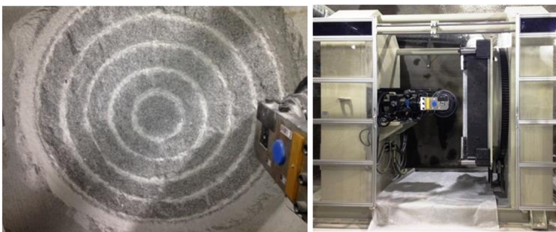
شکل ۲- آزمایش بزرگ مقیاس برش دورانی برای تعیین پارامترهای بهینه هندسه برش (Farrokh, et al., 2015)
