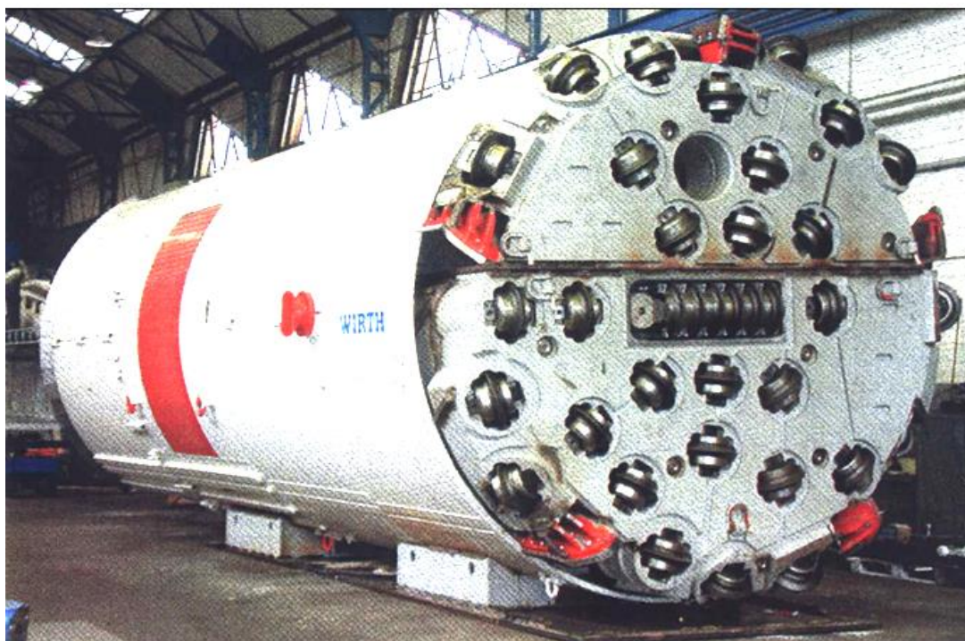
شکل ۲- نمایی از کله حفار ماشین تونل‌زنی تونل قمرود
