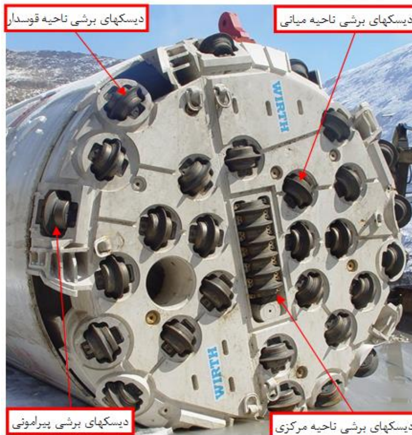
شکل ۵- انواع مختلف دیسک‌های برشی روی کله حفار
