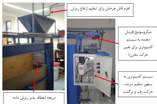
شکل ۵- سیستم اتوماتیک پاشش ماسه
