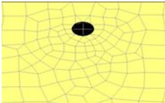
شکل ۳- المان‌بندی و موقعیت تونل در روش اجزای محدود
