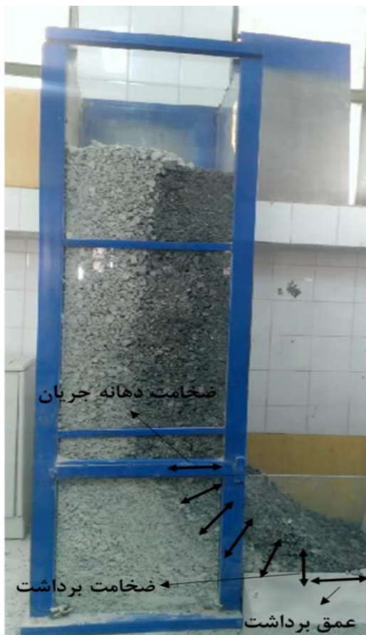
شکل ۱۶- تأثیر عمق برداشت بر تغییر ضخامت دهانه و تأثیر آن بر جریان
