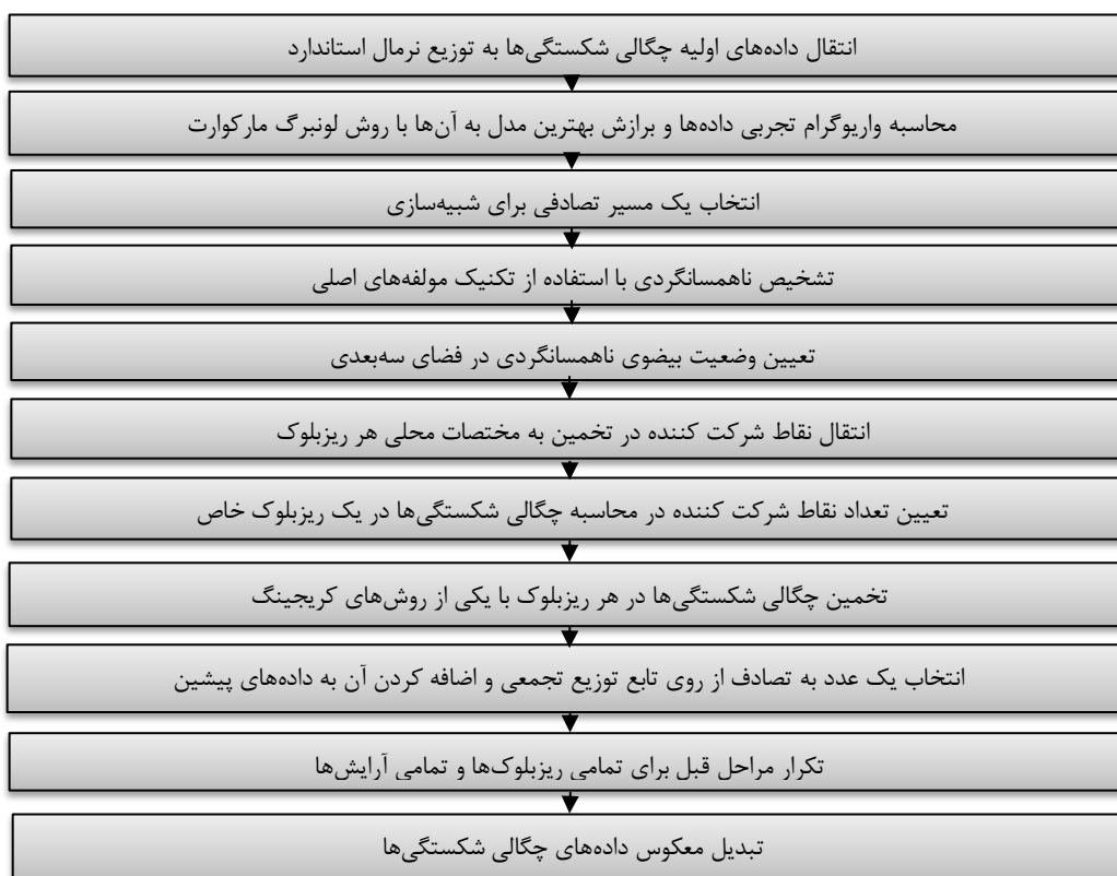
شکل ۱- فلوچارت تولید چگالی شکستگی‌ها به روش شبیه‌سازی گوسین متوالی
