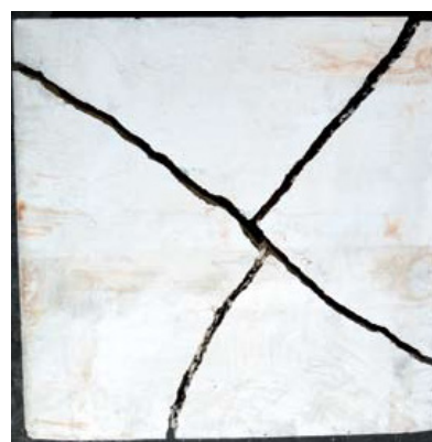
شکل ۲- ساز و کار شکست پانل بتن غیر مسلح و تعریف جذب انرژی بر اساس سطح زیر منحنی نیرو-تغییر شکل
