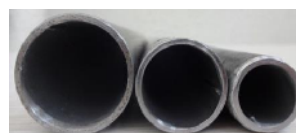
شکل ۴- لوله با اندازه‌های مختلف به منظور ایجاد مقادیر متفاوت قطر و افت‌زمین
