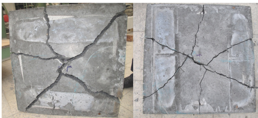
شکل ۳- ساز و کار بارگذاری و شکست نمونه‌های بتن الیافی در آزمایش پانل
