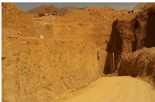
شکل ۳- روش استخراج سطحی برای دسترسی به ذخیره در معدن سنگ ساختمانی کپیول
