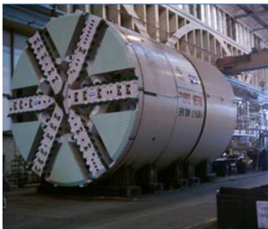
شکل ۲- ماشین حفار خط یک مترو تبریز ( NFM Technologies, 2007 )
