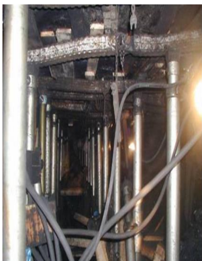
شکل ۱- نمایشی از نگهداری با پایه‌های هیدرولیکی
