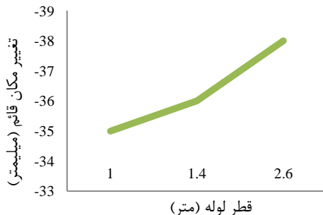
شکل ۱۳- درصد تغییرات تغییر مکان قائم نسبت به عمق در مدل‌های با تغییر قطر لوله
