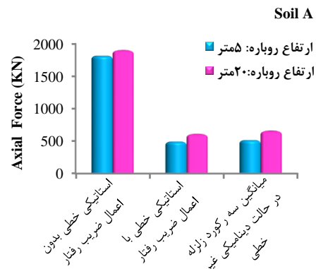
شکل ۲۰- مقایسه‌ی نیروی محوری پوشش تونل در حالت استاتیکی و دینامیکی برای خاک A
