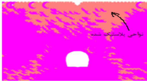
شکل ۱۲- نواحی پلاستیک شده در لحظه انفجار ۲۵ کیلوگرم TNT در سطح خاک
