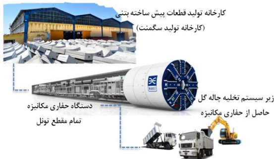
شکل ۱- سیستم حفاری مکانیزه شامل زیرسیستم‌های کارخانه تولید قطعات پیش‌ساخته بتنی (کارخانه سگمنت)، زیرسیستم حفاری مکانیزه و زیرسیستم تخلیه گل حفاری
