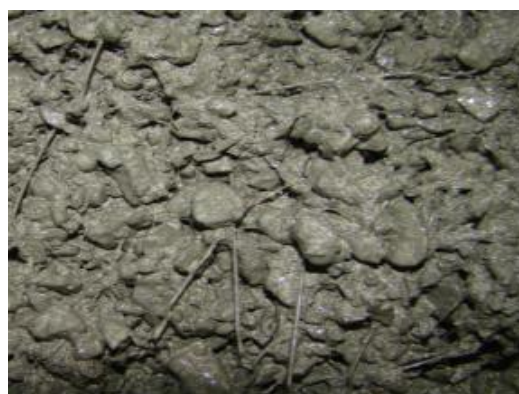
شکل ۵- بتن ساخته شده با الیاف فولادی در پروژه
