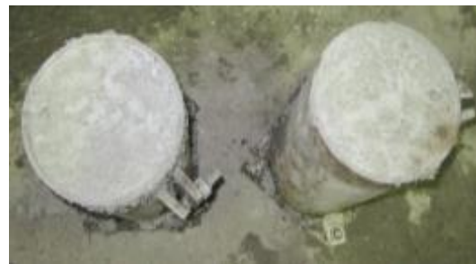
شکل ۹- نمونه‌های استوانه‌ای عمل‌آوری شده با بخار برای آزمایش برزیلی
