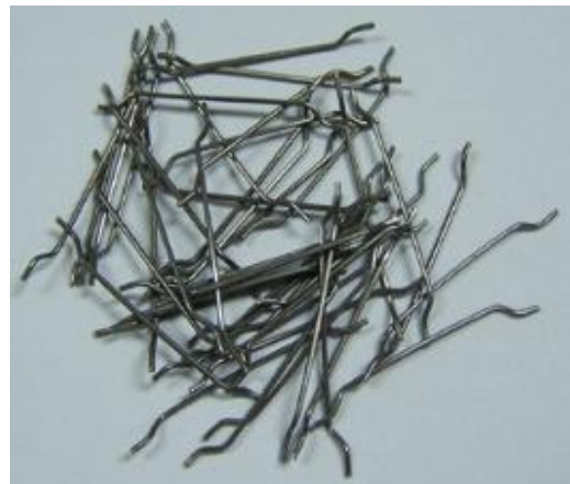
شکل ۲- الیاف فلزی مصرفی در پروژه
