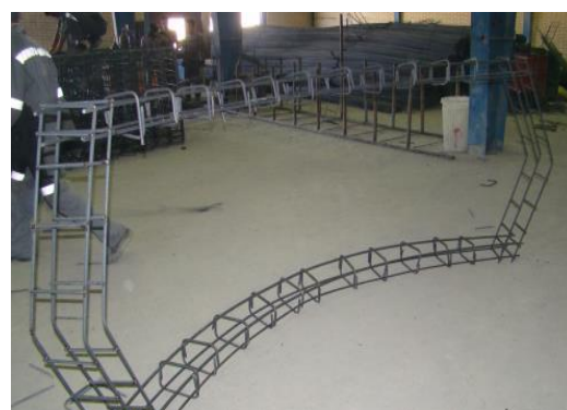
شکل ۶- سبد مورد استفاده در سگمنت الیافی در پروژه گلاب
