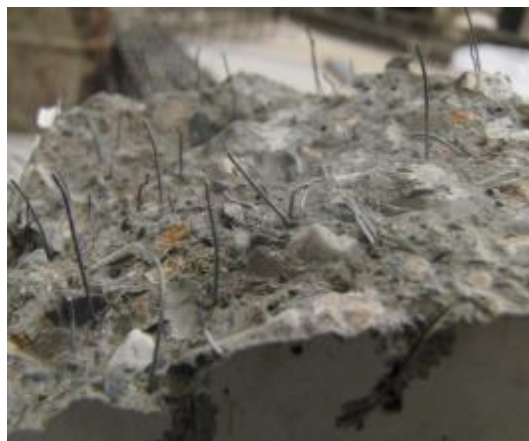
شکل ۱۲- توزیع الیاف در نمونه منشوری
