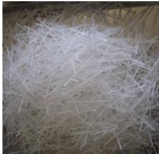
شکل ۳- الیاف ماکرو پلی‌پروپیلن مصرفی در پروژه
