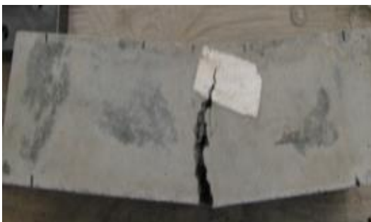
شکل ۱۱- نمونه منشوری بتن مسلح به الیاف فلزی گسیخته شده تحت خمش
