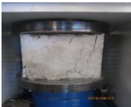
شکل ۷- نمونه مکعبی بتن الیافی تحت فشار تک‌محوره
