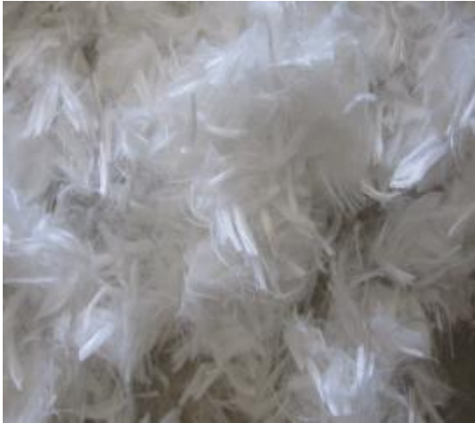
شکل ۴- الیاف میکرو پلی‌پروپیلن مصرفی در پروژه
