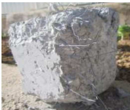
شکل ۸- نمونه مکعبی بتن الیافی گسیخته شده تحت فشار تک‌محوره
